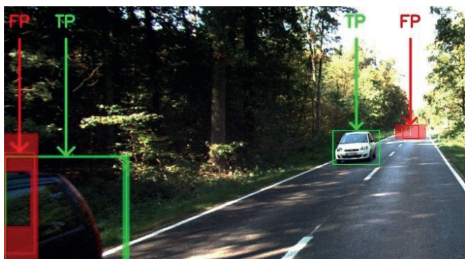
Abbildung 8: Bei diesem Beispiel detektiert das System zunächst vier Objekte, wovon nur zwei korrekt sind und demnach als True Positive (TP) bezeichnet werden. Die beiden Falsch-Vorhersagen, also False Positives (FP), lassen sich jedoch herausfiltern, da sie mit einer hohen Unsicherheitsschätzung einhergehen. Abbildung: Fraunhofer IAIS
